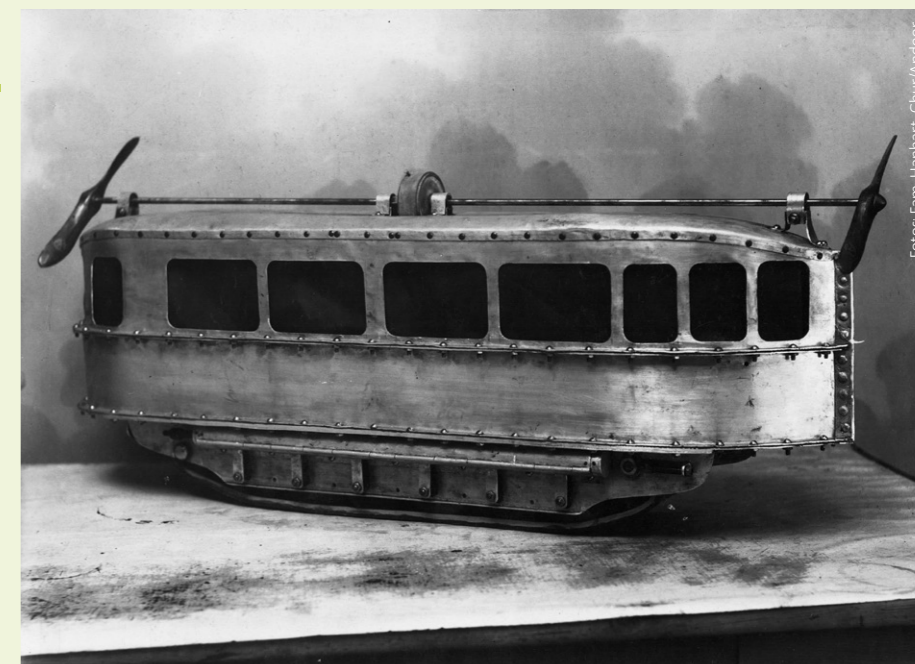
Das Hanart'sche Modell eines Schneefahrzeugs mit Luftschauben 1925.
